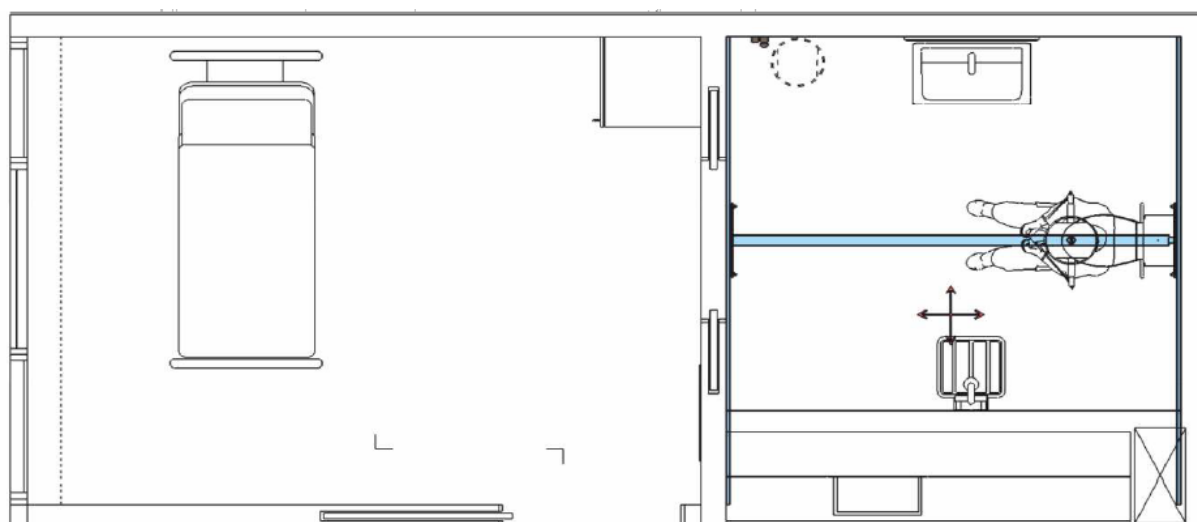
Рисунок 3.2 – Система для подъема и перемещения пациентов рельсовая (потолочная, настенная) медицинская «ОРТОРЕНТ ПРМ-02». Вариант установки в одной комнате. Вид сверху. Настенная установка
