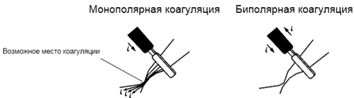
Рисунок 3 – Направление движения ВЧ тока при различных режимах работы
